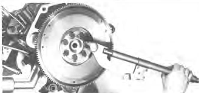
– Bei ZF das Halteblech des Drehmomentwandlers
